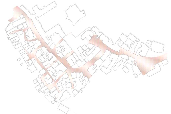
Für die Zukunftsvision der Altstadt soll ein einheitlicher Belagskanon entwickelt werden. Ein wird ein Betonsteinpflaster in unterschiedlichen Formen vorgeschlagen. Die Farbigkeit nimmt Bezug auf die traditionell vorhandenen warmen Töne des Buntsandsteins.
