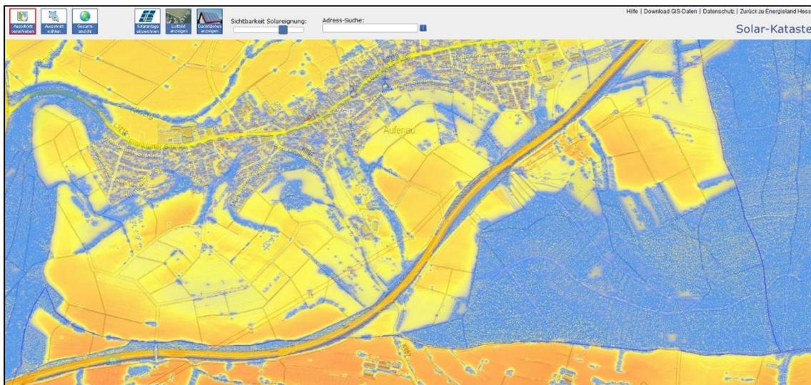
Abb.: Solar-Kataster Hessen, Ausschnitt Aufenau (dunklere Färbung = höhere Globalstrahlung)
